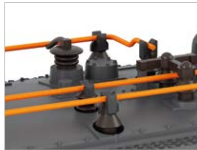
■ Neue filigrane Isolatoren und Dachleitungen
