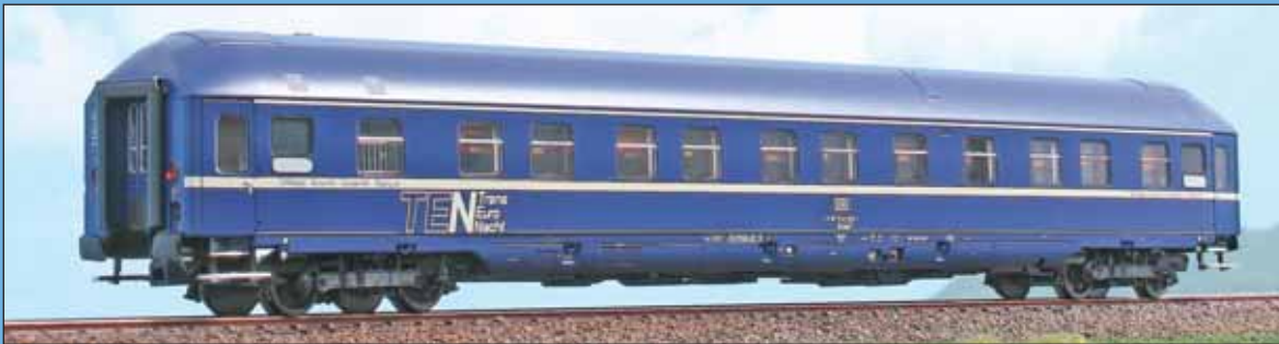
Carrozza letti WLABmh 174 delle DB, in livrea TEN blu. Sleeping car WLABmh 174 with Minden bogies of DB, TEN blue livery. Schlafwagen Typ WLABmh 174 mit Minden Drehgestellen der DB, TEN Blau Lackierung.
