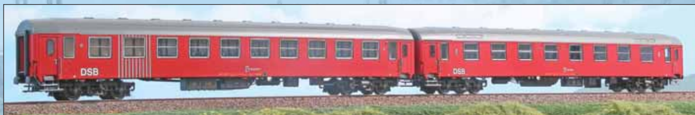
Set composto da due carrozze Tipo Y DSB, una ex 1 a classe e una ex Bk. Set consisting of two type Y DSB cars, a former 1 st class and a former Bk. Set bestehend aus zwei DSB-Wagen vom Typ Y, einem ehemaligen 1. Klasse und einem ehemaligen Bk.
