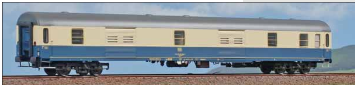
Bagagliaio Dms 905 DB livrea blu e crema con quattro porte. DB Luggage car Dms 905 in blue and cream livery, with four doors. Gepäckwagen Dms 905 der DB, mit vier Türen, Ozeambau/beige-Lackierung
