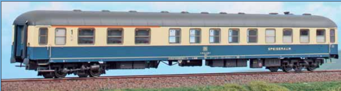
Carrozza ARmz 216 mista di prima classe e ristorante in livrea blu/beige Typ X ARmz 216 mixed first class/restaurant DB car in bleu/beige livery. Schnellzugabteilwagen mit Speiseraum der DB, Typ ARmz 216 , ozeanblau/beige Lackierung und graues Dach.
