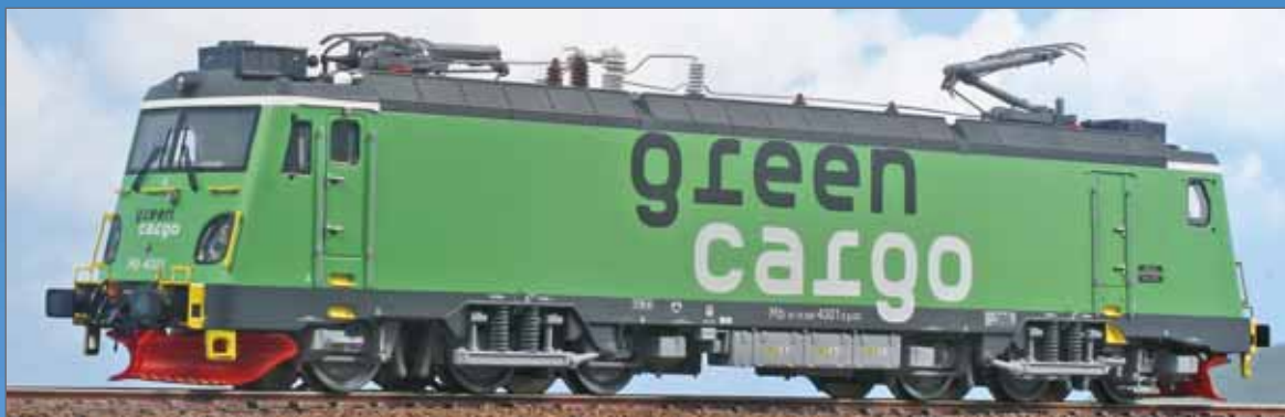
Locomotiva elettrica Trasmontana di terza serie in servizio presso Green Cargo (Svezia). Electric locomotive Trasmontana, third series, in service at Green Cargo (Sweden). Trasmontana-Elektrolokomotive der dritten Serie, im Einsatz bei Green Cargo (Schweden).
