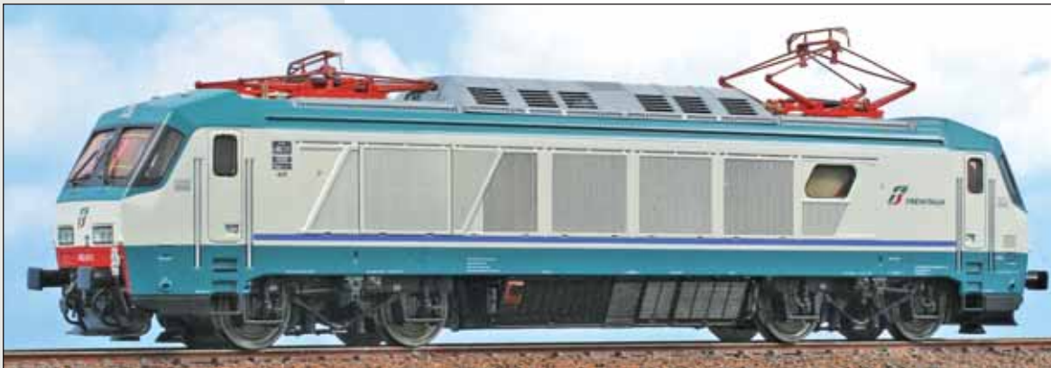
Locomotiva elettrica E.402.031 di Trenitalia, in livrea XMPR con connettori per il comando lateralizzato per le porte del treno. Electric locomotive E.402.031 of Trenitalia, in XMPR livery with sockets for independent side control of the train doors. Lokomotive E.402.031 der Trenitalia, in XMPR Lackierung, mit Steckdosen für die seitenabhängige Steuerung der Zugtüren
