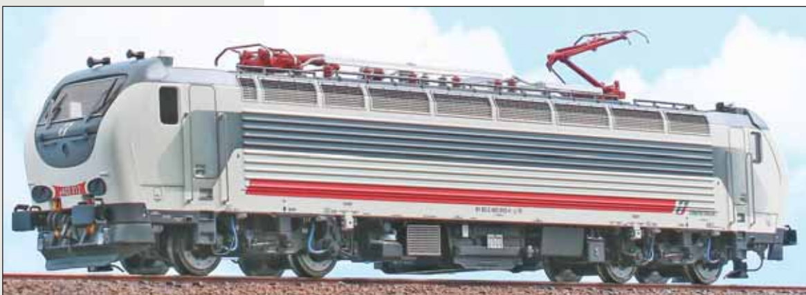
Locomotiva E.403 012 nella livrea attuale "Intercity Day", con due pantografi. Locomotive E.403 012 in the actual "intercity Day" with two pantographs. Lokomotive E.403 012 in der aktuellen „Intercity Day“-Lackierung und mit zwei Stromabnehmer.
